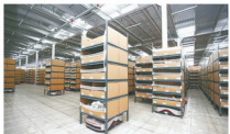
在京东物流厦门“亚洲一号”物流园内，由京东物流自主研发的“地狼”机器人正“背”着货架来回穿梭，井然有序地为分拣工作人员传送“快递”。
