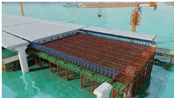
图10 BIM技术应用于大临工程布置
