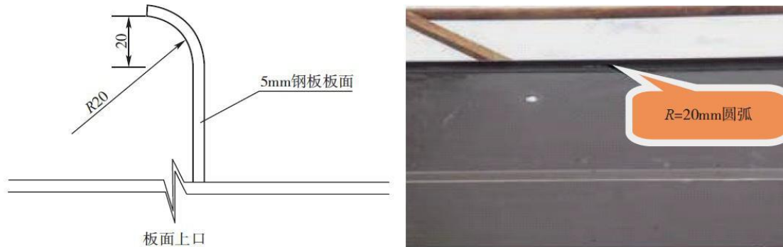
图 1.1.2-7 模板内表面的 2cm 圆弧
