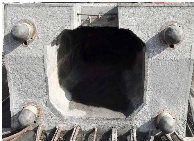
图 1.1.2-11 预制空心板可调节式刚性内模浇筑效果
