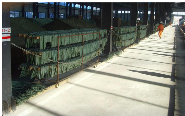
图 1.6.2-1 成品环氧涂层钢筋的存放
