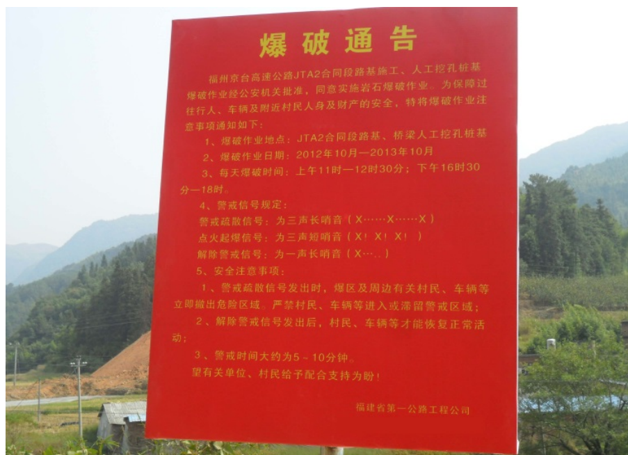
图 6.18 爆破通告：爆破现场应提前设置，告知爆破时间安排。
